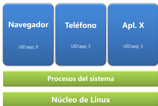
Fig. 1. Esquema del funcionamiento de Android. Cada aplicación se ejecuta en su propia máquina virtual, denominada Dalvik
